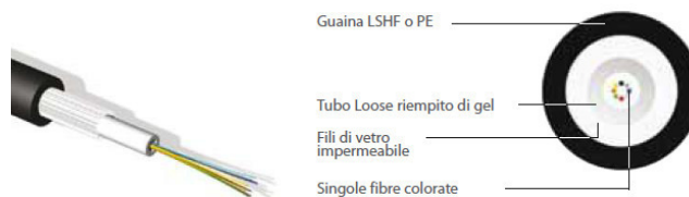
Cavo in fibra ottica di tipo loose
