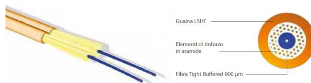
Cavo in fibra ottica di tipo tight
